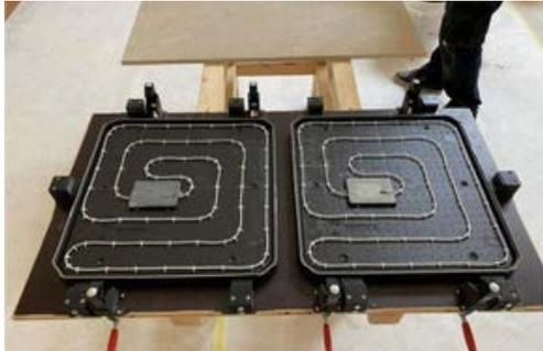
1) Rohmodule in Spannvorrichtung einlegen
