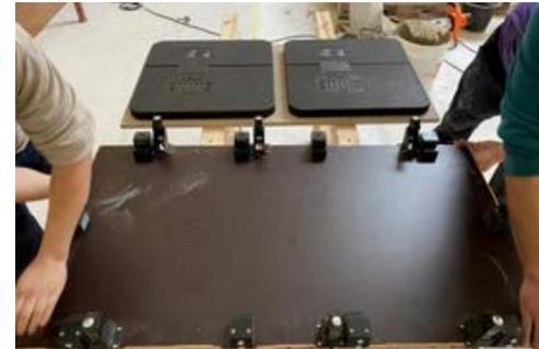
7) Spannvorrichtung lösen
