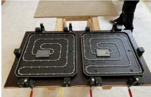
1) Rohmodule in Spannvorrichtung einlegen
