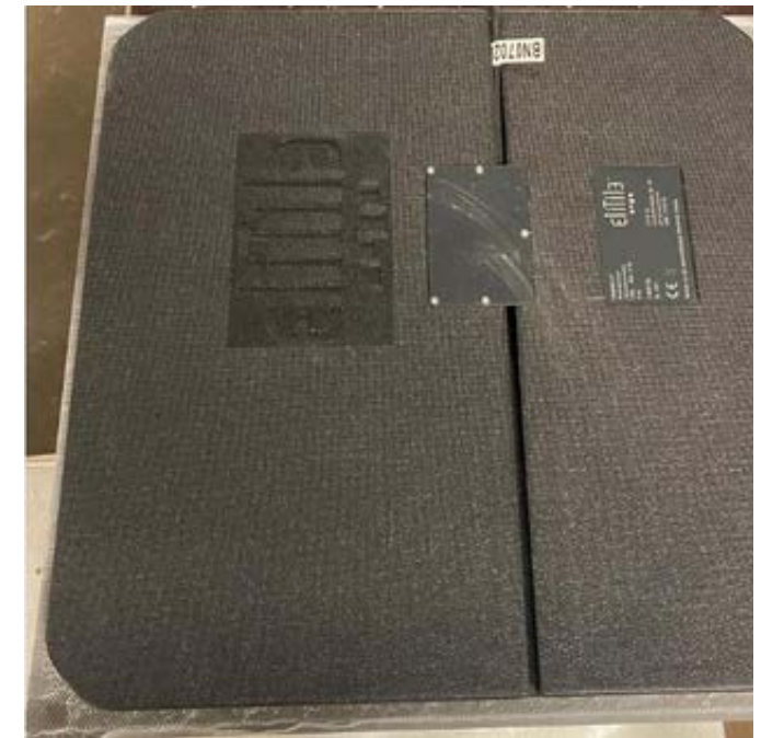
Fixierung des Heizmoduls an der Fliesenunterseite
